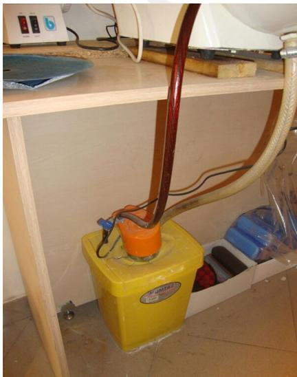
آبرسانی دستگاه با یک پمپ آب کولر آبی و یک سطل می باشد. شلنگ قرمز ورودی آب به دستگاه که فشار آن قابل تنظیم است، شلنگ سفید جهت خروجی آب از دستگاه تراش به درون سطل میباشد (شکل ۱۹).
